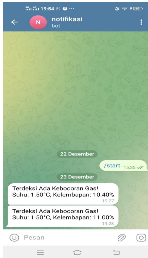
Gambar 13 tampilan pesan saat alat mendeteksi kebocoran gas dan suhu ,kelembapan
