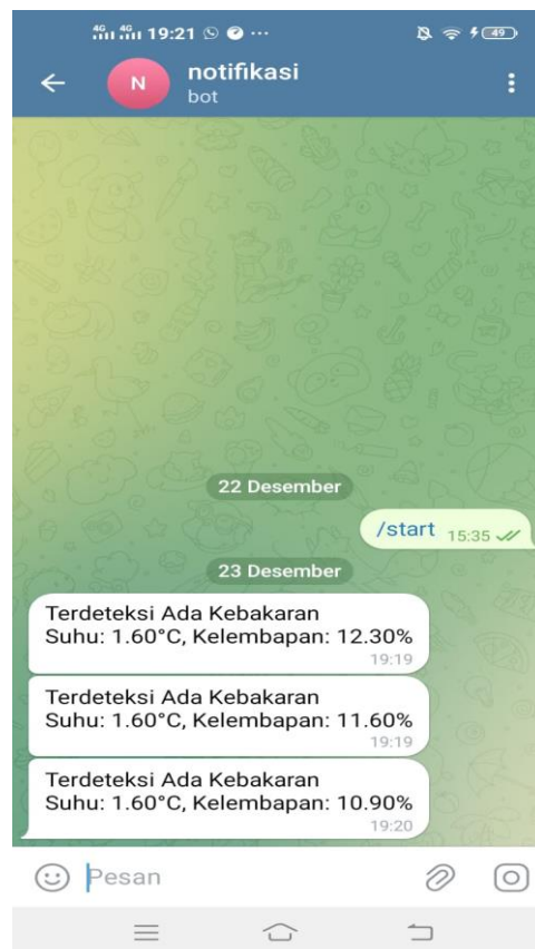
Gambar 14 tampilan pesan saat alat mendeteksi kebakaran dan suhu ,kelembapan
