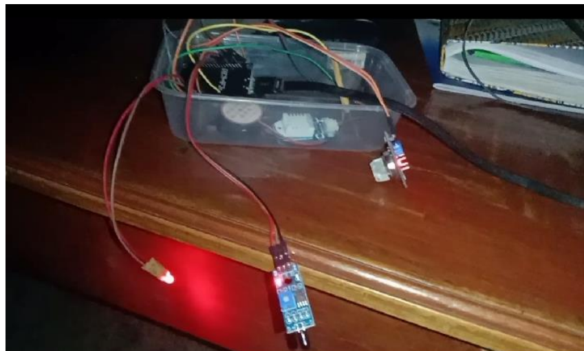
Gambar 11 Realisasi dari alat Sistem Deteksi Gas dan Kebakaran Dini ESP8266 dengan Notifikasi Telegram, Buzzer, dan Pemantauan Suhu dan Kelembapan
