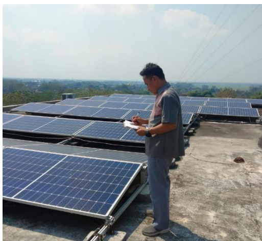
Gambar 4 Pencatatan irradiance dan suhu PV
